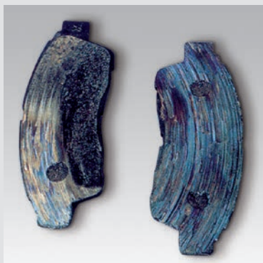
► Material de fricțiune uzat până la placa de fixare din oțel
