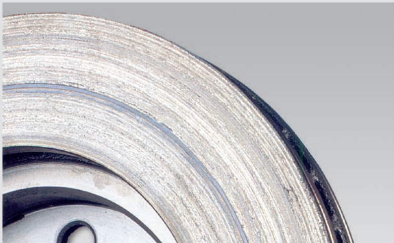
► Disc de frână cu urme de zgârieturi
