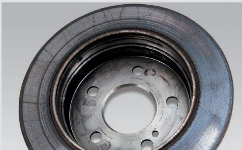
► Disc de frână cu puncte statice
