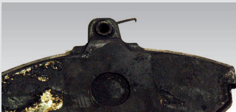
► Arc de presare rupt
