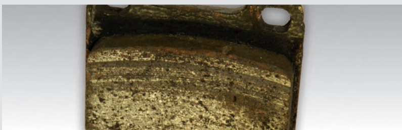
► Zgâriere adâncă a suprafeței plăcuței
