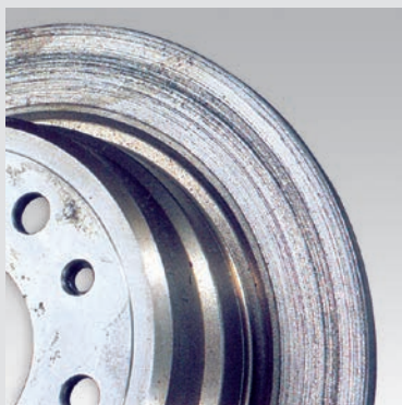
► Discuri de frână deteriorate de materialul de fricțiune uzat
