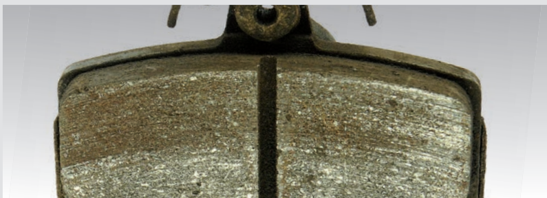
► Contaminarea suprafeței de fricțiune
