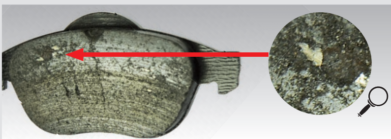
► Reziduuri – așchii de metal în suprafața plăcuței
