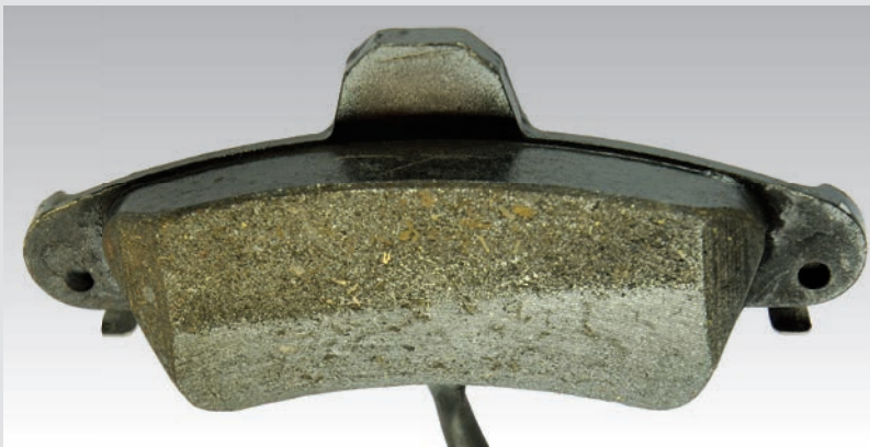
► Plăcuță cu structură de contact necorespunzătoare
