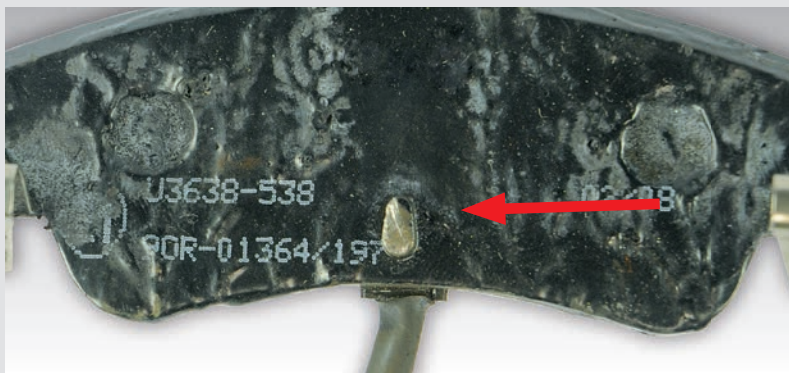
► Amprenta pistonului pe dispozitivul de poziționare
