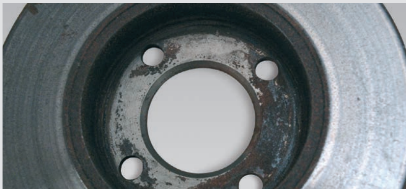
► Coroziune severă a substratului
